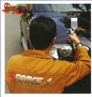
専用コンパウンドによる下地処理後、パネルごとに硬化促進剤のスプレー作業。
